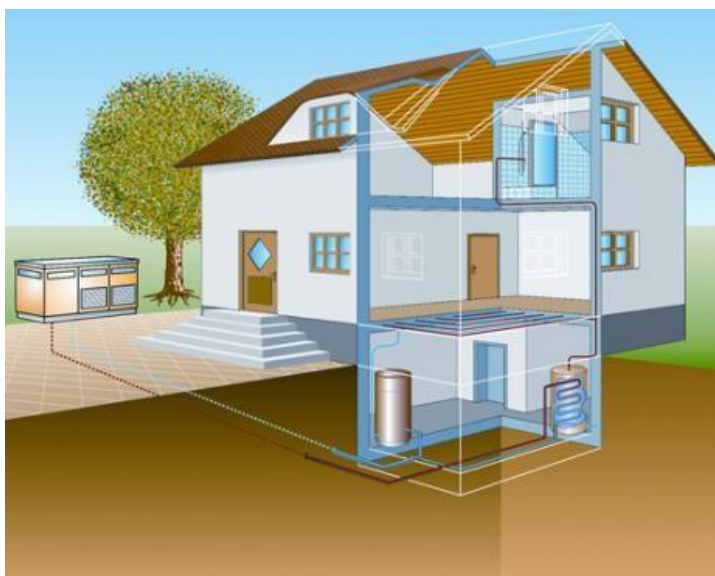
Rysunek 10 Schemat instalacji z powietrzną pompą ciepła. 26
