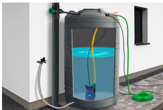
Rys.10. Nadziemny zbiornik na deszczówkę
